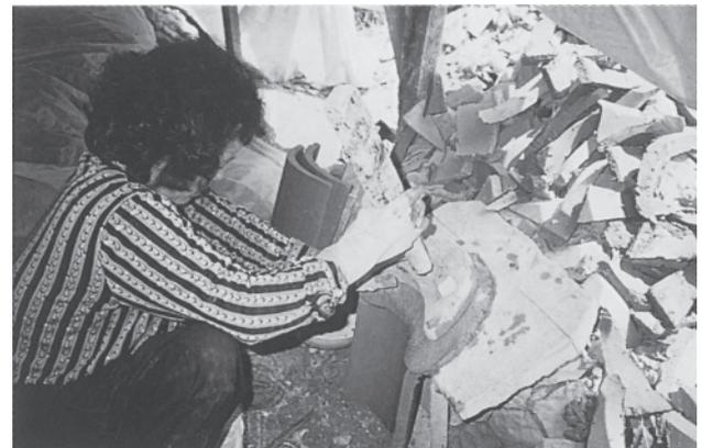
写真8 滴水瓦の型を叩く作業
