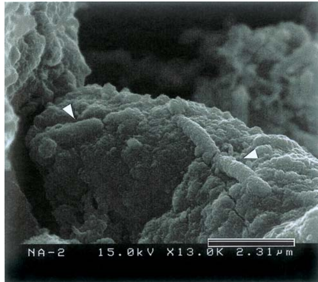
写真3：高師小僧の鉄酸化物中の微小空隙中で確認されたロッド状の微生物の痕跡(矢印)と思われる形態の電子顕微鏡写真。
