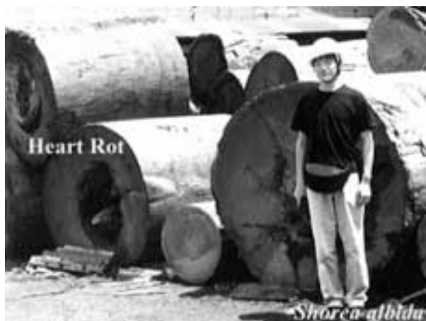
メランチ材のハートロット
